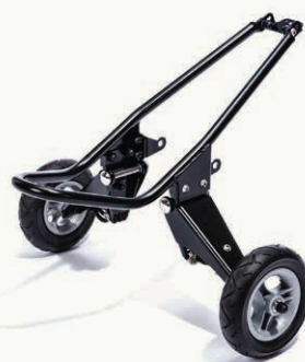
Stützradrahmen als Montagesatz für handelsübliche Zweiräder (Naben-Einbaubreite min. 120 mm)
